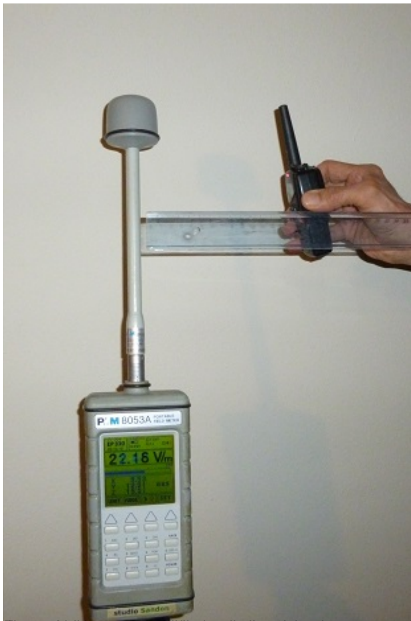
Fig. 2.5. Campo elettromagnetico generato da una ricetrasmittente PMR446 a 36,96 MHz
